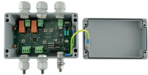
Le contrôle par différentiel thermique sert à l'identification des défauts de l'installation, plus particulièrement des lampes qui ne seraient pas raccordées. Le contrôle est automatiquement activé dès que les lampes sont éteintes.
