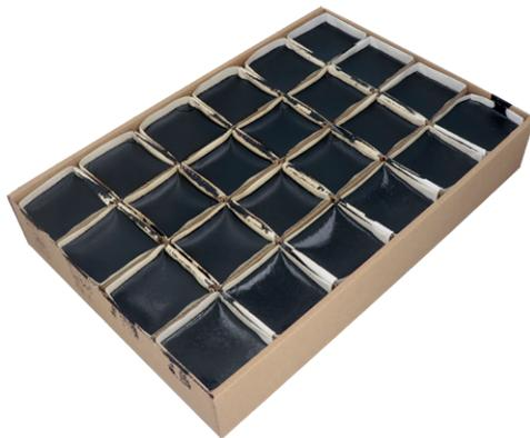
Pour être utilisé, la masse d'étanchéité bitume recommandée doit être chauffée de 160° à 180° C en remuant constamment. Le remplissage se fait à l'aide d'un récipient à bec où d'un bec de coulée. Le scellement en excès doit être enlevé mécaniquement après refroidissement complet.
